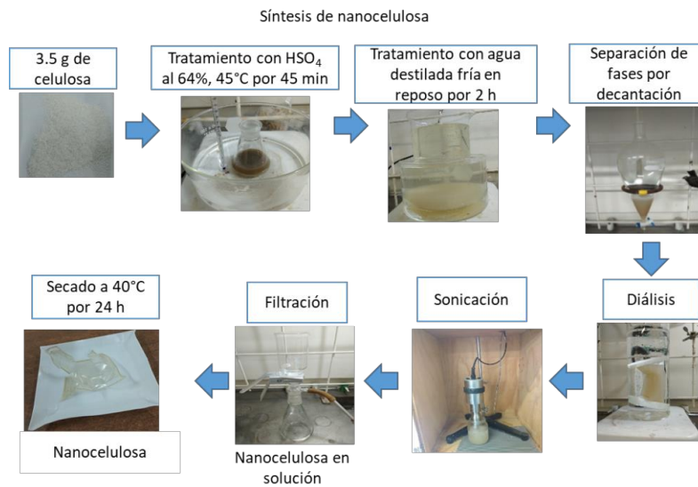
Fig. 6. Diagrama de bloques de la síntesis de nanocelulosa a partir de la biomasa de sargazo.
