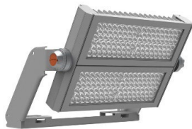
Fig. 10. Detalle de la luminaria LEDVANCE FLOODLIGHT MAX 600 donde se aprecian las 2 matrices de LEDs independientes que permiten una fácil regulación al 50% de intensidad.
